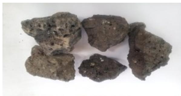
Fig. 1. Blast furnace slag
